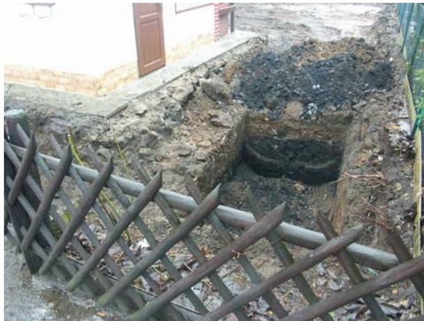
Baggerschurf in einer Kleingartenparzelle. Oberflächennah sind für die Ablagerung typische bräunliche Abfallschichten zu erkennen, darunter in geringer Tiefe (< 1 m u. GOK) dunkelbraune bis schwarze Lagen eines auffällig riechenden Materials – wie sich herausstellt ein natürliches Umsetzungsprodukt namens ‚Mudde‘, welches anaerob aus organischer Substanz im Bereich von Mooren entstanden ist.
